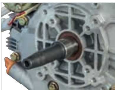
Albero lungo generatore Generator shaft
